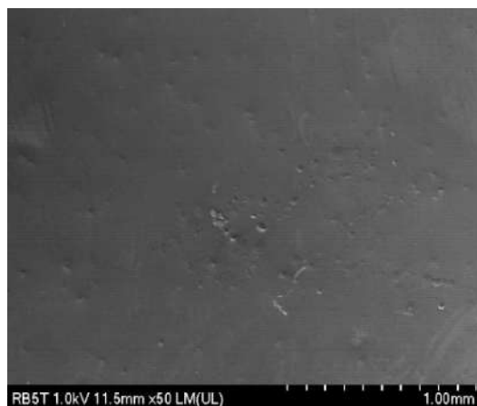
Figura 25.- HRSEM de recubrimiento base (RB) con 5 min de residencia sobre las placas de acero inoxidable
