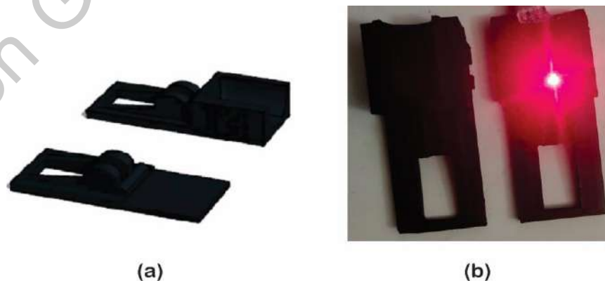
Figura 3.3. Diseño del capuchón del sensor de frecuencia cardiaca y oxigenación en sangre (a) diseño virtual, (b) diseño creado (Autoría propia).
