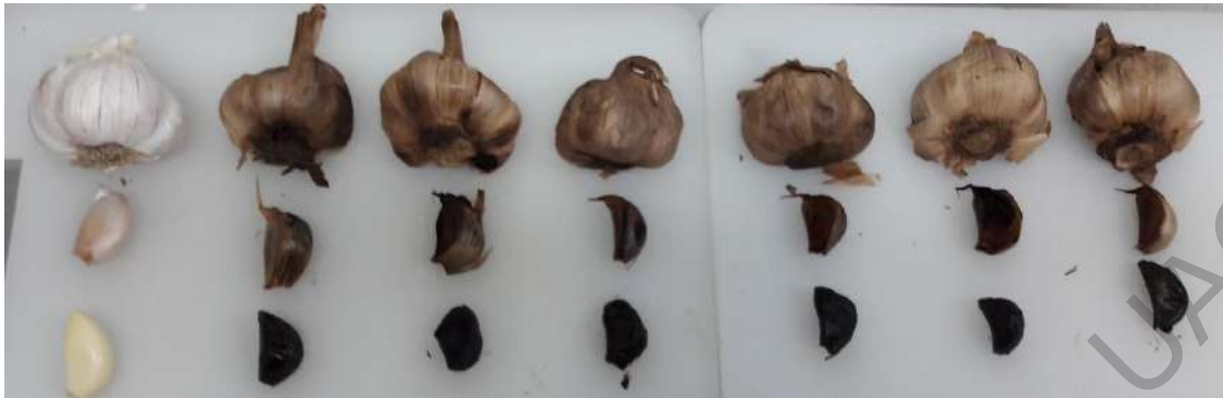
Figura 36. Color interno y externo de ajo almacenado a 16 días con diferentes tiempos de sonicación (de izquierda a derecha: ajo crudo, T0, T1, T2, T3, T4 y T5). T0 = control, T1 = 3 min, T2 = 5 min, T3 = 10 min, T4 = 15 min, T5 = 20 min.
