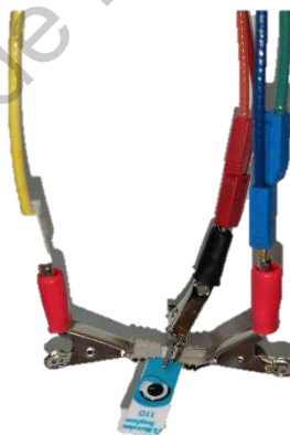
Figura 46. Electrodo serigrafiado conectado al potenciostato
