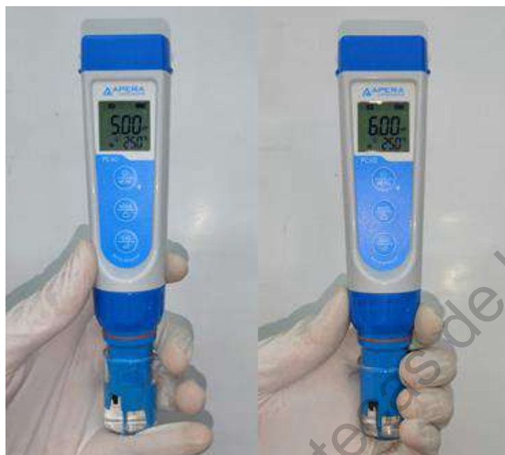
Figura 9. Lectura del potenciómetro dos soluciones amortiguadoras. (Fuente propia).
