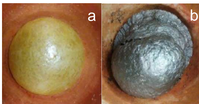
Figura 5.5. Gel después de secar (a) y tras el tratamiento térmico de calcinación (b).
