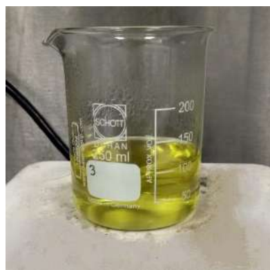
Figura 5.1. Etapa de evaporación del proceso sol-gel.
