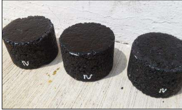
Pastillas con riego de liga en proceso de curado.
