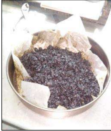
Calentamiento de mezcla asfáltica.
