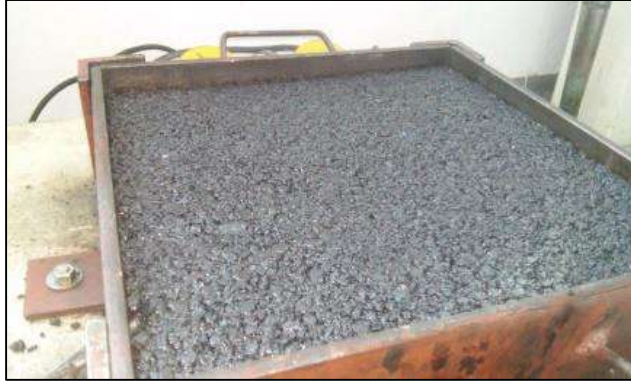
Fabricación de losa de concreto asfáltico.
