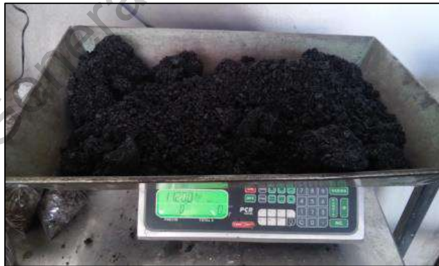
Pesaje de mezcla asfáltica utilizada para elaboración de pastillas Marshall.
