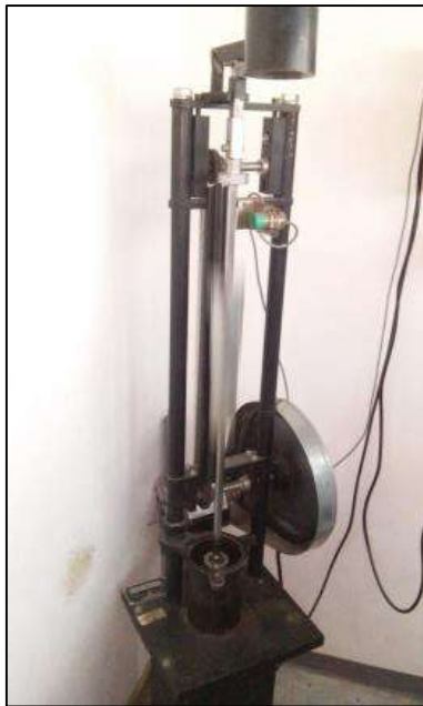
Compactador Marshall utilizado para elaborar pastillas.
