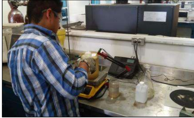
Medición de PH en solución jabonosa.
