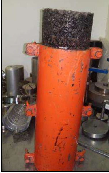
Montaje de pastillas en moldes de dispositivo LCB.
