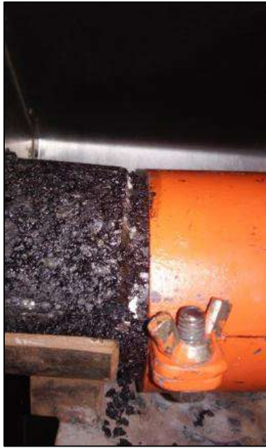
Proceso de falla durante aplicación de carga en ensayo LCB.
