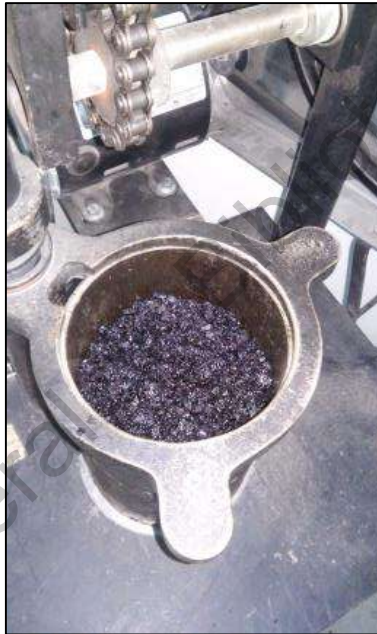
Colocación de mezcla asfáltica en moldes Marshall previo a compactación.
