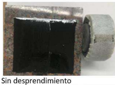
Figura 2.10 Ensayo de Desprendimiento con rueda cargada. Fuente: Lv y Bahia (2018)
