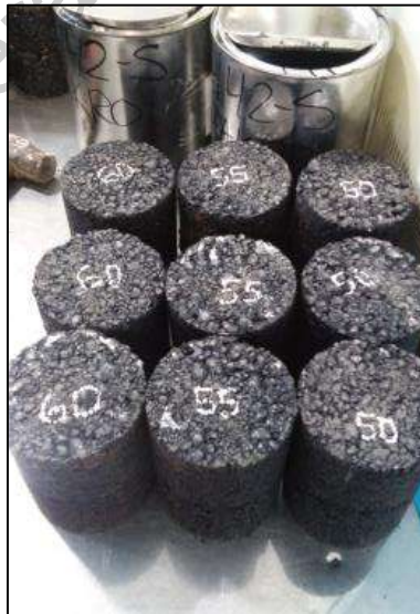
Pastillas para ensayo Laboratorio de Caminos de Barcelona.
