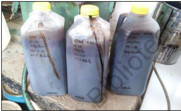
Emulsión asfáltica rápida con contenido asfáltico de 50%, 55% y 60%.
