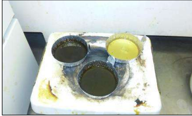
Contenido de ligante para emulsión asfáltica.
