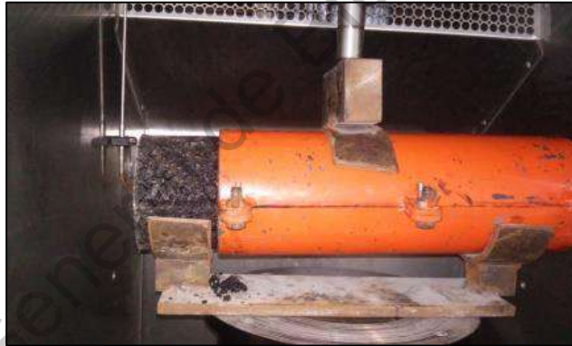
Montaje de dispositivo LCB en prensa hidráulica.
