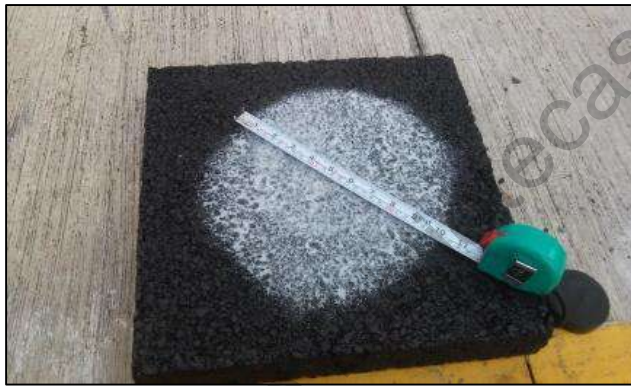
Ensayo de círculo de arena.
