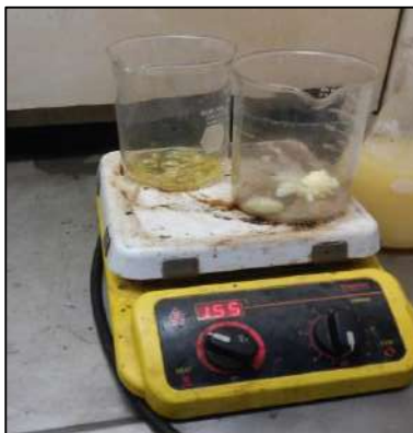
Calentamiento de emulsificante C25 para emulsión rápida.
