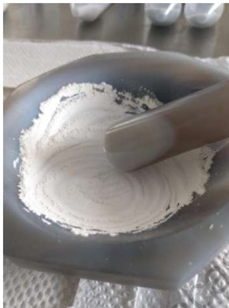
Ilustración 4-7 Polvo pulverizado ZnS:Mn
