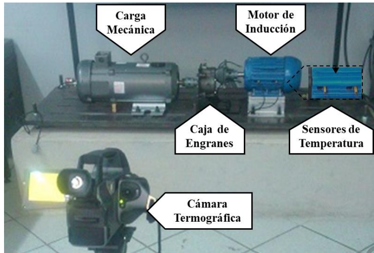
Figura 10. Banco de pruebas experimentales basado en una cadena cinemática.
