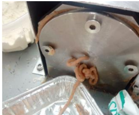
Figura 38. Masa extruida a una temperatura de 110-120°C
