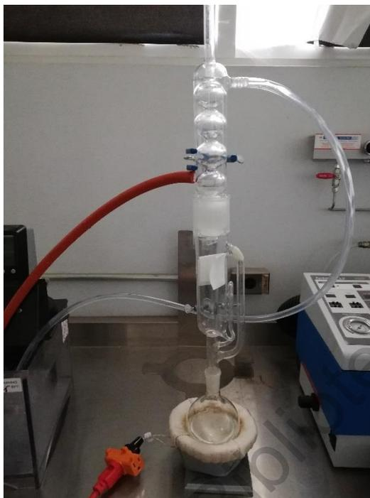
Figura 5. Equipo Soxhlet para extracción de grasas.
