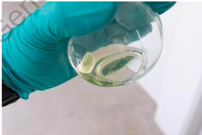
Figura 18. Muestra titulada con tiosulfato de sodio
