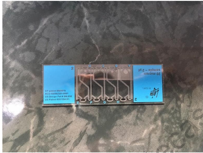
Figura 14: Cámara Leja para sistema CASA.
