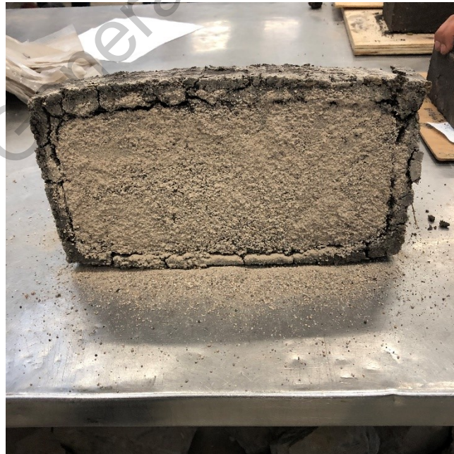
Ilustración 48. Vista inferior de falla de bloques.
