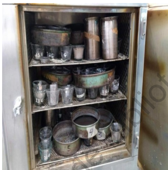
Ilustración 9. Colocación de muestras en horno para eliminar humedad.
