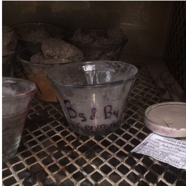
Ilustración 30. Colocación de testigos de humedad en horno.
