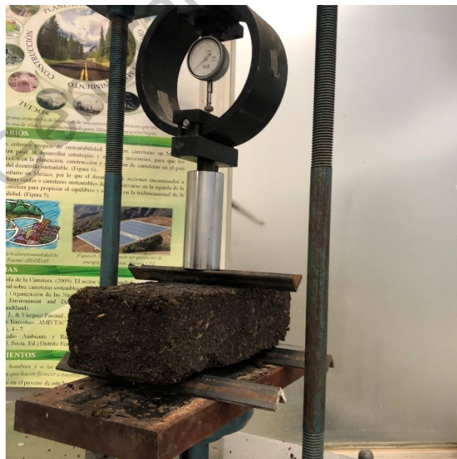
Ilustración 49. Ensayo a flexión.
