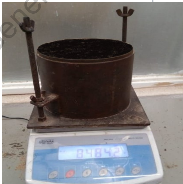
Ilustración 29. Pesado de molde con suelo compactado.
