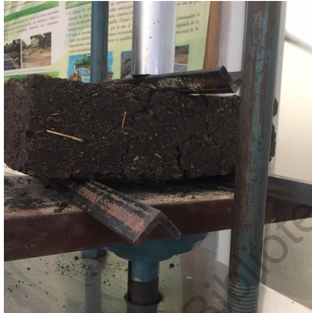
Ilustración 50. Falla a flexión en bloques.
