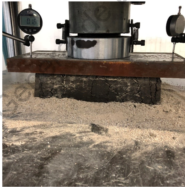
Ilustración 46. Ensayo de compresión en bloques, con medición de deformación.
