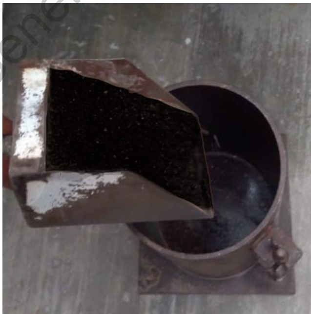
Ilustración 26. Vaciado de suelo en molde.
