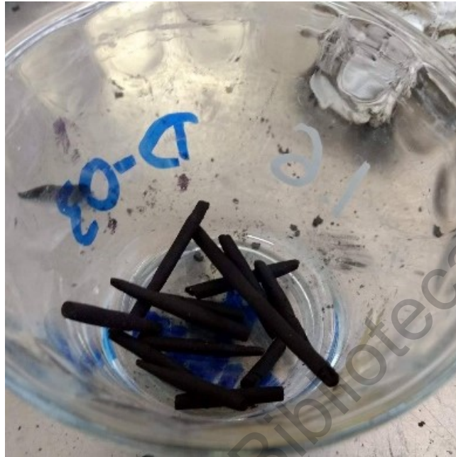
Ilustración 22. Muestra de rollitos de suelo en punto requerido.
