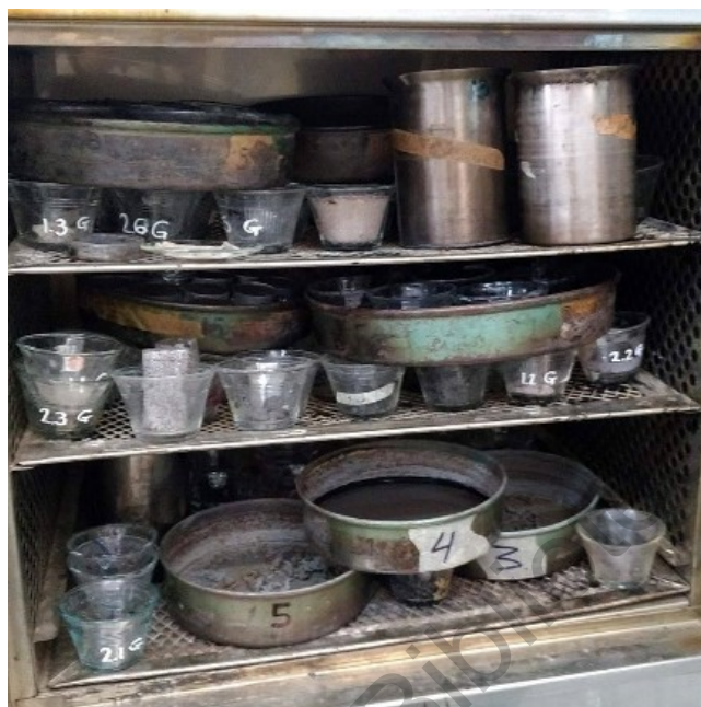
Ilustración 18. Secado al horno de testigos de humedad.
