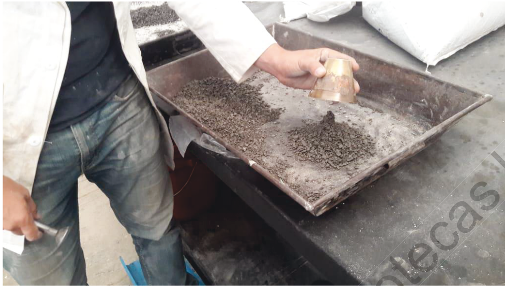
Figura 16. Arena es estado saturado y superficialmente seco para el cálculo de su absorción
