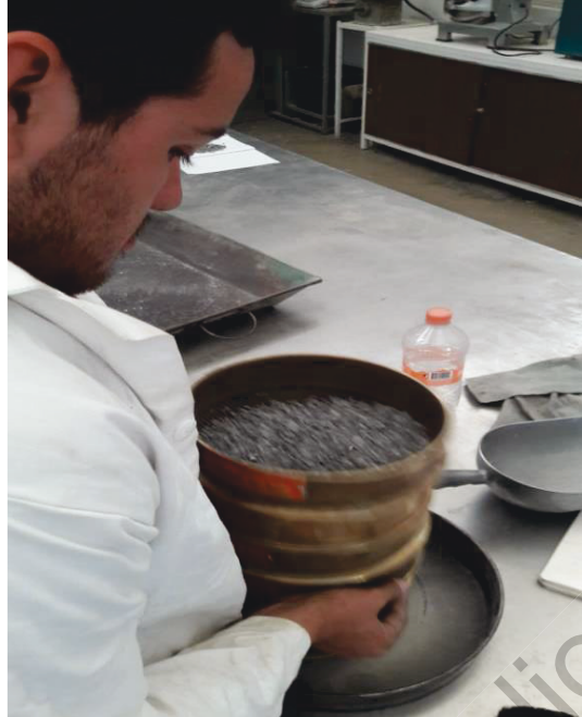
Figura 8. Cribado del agregado fino para la obtención de la curva granulométrica
