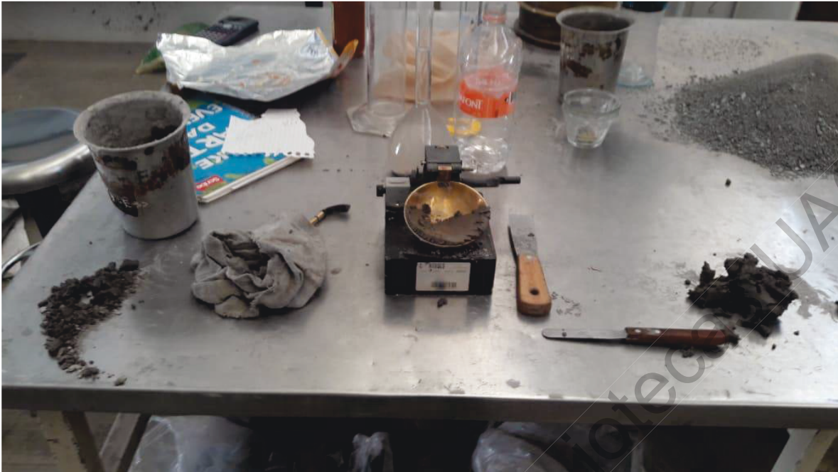
Figura 18. Determinación del límite líquido por medio de la copa de Casagrande
