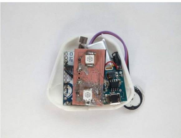
Figura 30. Disposición de circuito en carcasa. Elaboración propia
