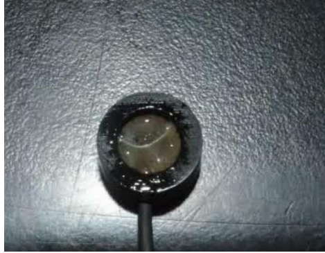
Fig. 4 Electrodo de superficie, cubierto con Gel transmisor.
