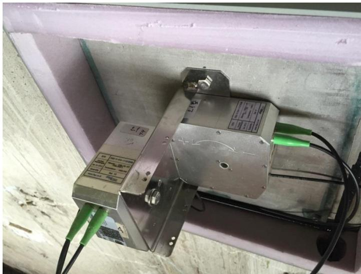
Figura 2.3 Inclinómetros instalados en estribo del Puente Mezcala
