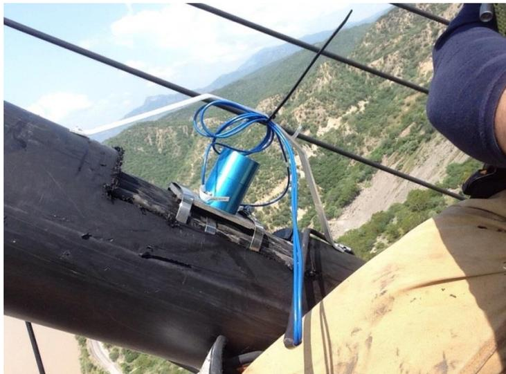
Figura 2.2 Acelerómetro instalado en tirante de sujeción del Puente Mezcala
