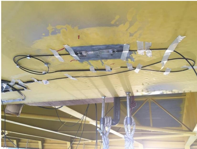
Figura 2.4a Extensómetro instalado en viga de acero
