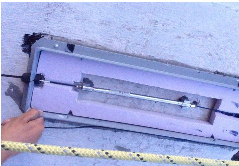
Figura 2.4b Extensómetro instalado en torre
