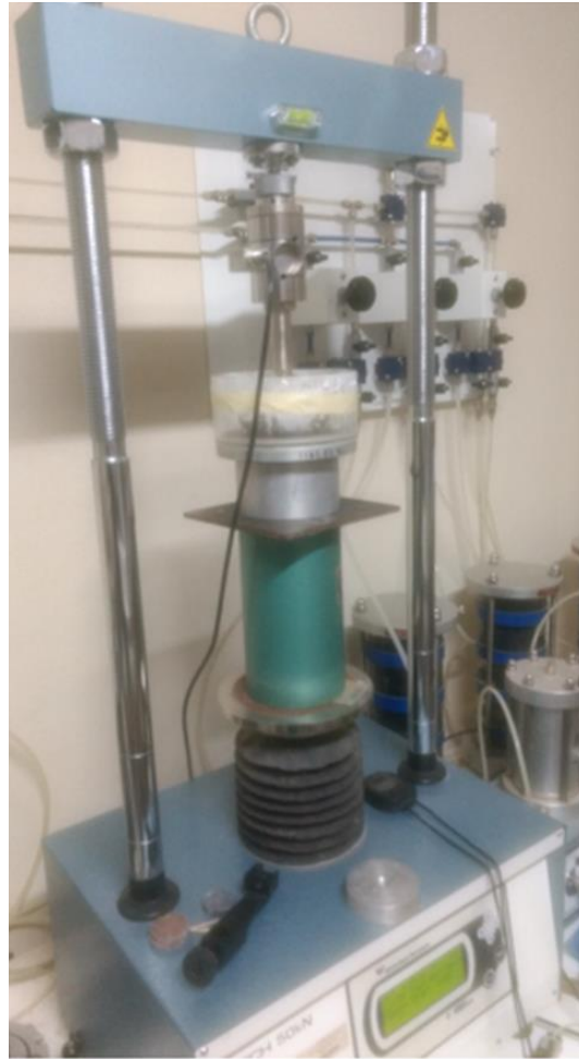
Figura 3-10.- Ensayo en prensa triaxial.
