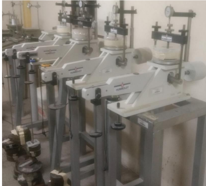
Figura 3-9.- Ensaye de consolidación del primer grupo.
