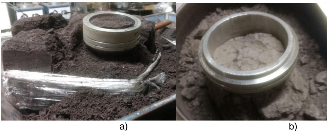
Figura 3-7.- Labrado de muestras, a) secado gradualmente al aire, b) secado completamente al horno.
