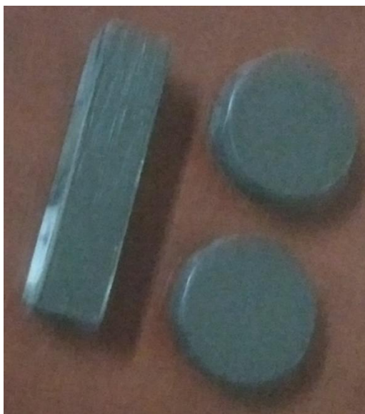
Figura 3-5.- Ensayo de límite de contracción.
