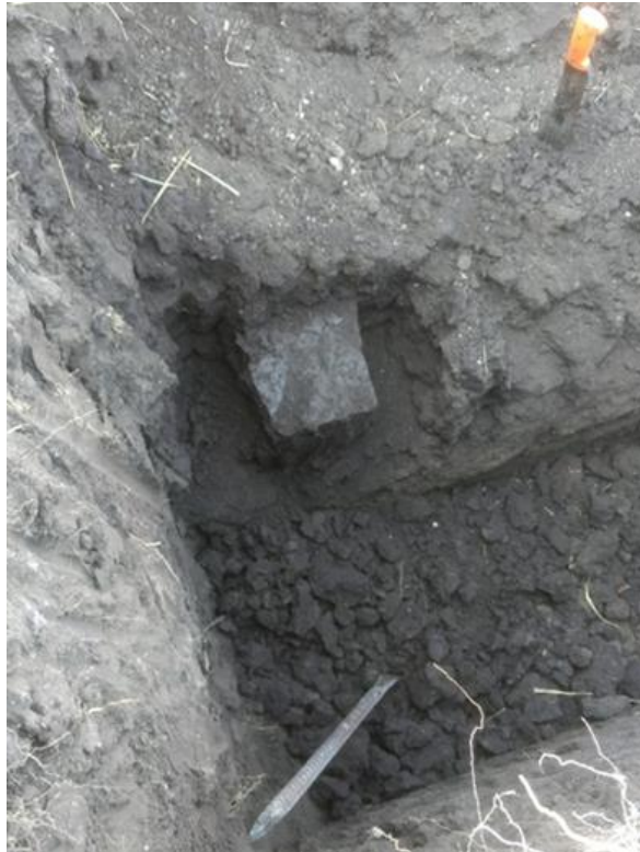
Figura 3-1.- Extracción de muestra inalterada.
