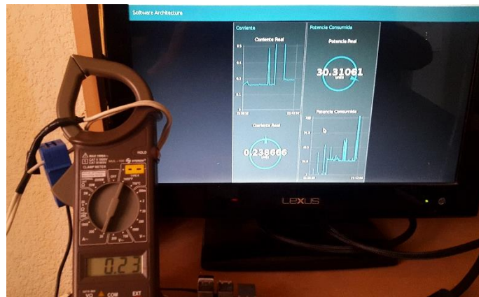
Figura 47. Verificación de lecturas utilizando un amperímetro y del prototipo. Fuente: Elaboración propia (2018).
