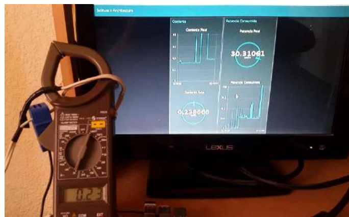
Figura 47. Verificación de lecturas utilizando un amperímetro y del prototipo. Fuente: Elaboración propia (2018).
