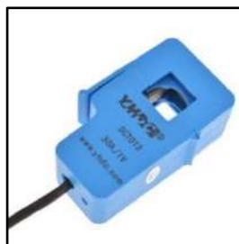
Figura 8. Sensor de corriente no invasivo SCT-013-030.
