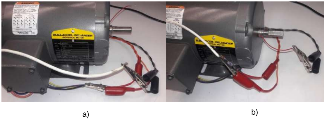
Figura 3.17 Medición impedancias a)de los embobinados ( C_r ) b)entre las fases y el rotor ( C_{wr1} ).
