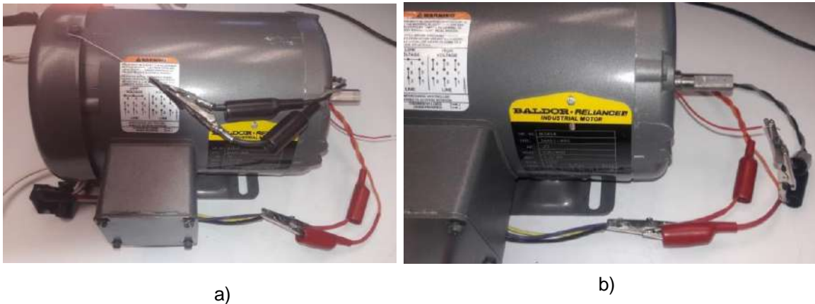
Figura 3.16 Medición de capacitancias parásitas a)entre el neutro y el estator ( C'_{wsN} ) b)entre el neutro y el rotor ( C_{wr2} ).
